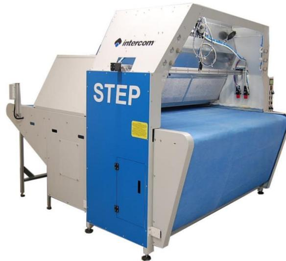
操作员将物料放置在传送带的软垫地毯上，机器将物料自动带到喷枪下方，在此处均匀地在材料上面喷涂粘合剂。然后，材料进入干燥通道，可以在任何气候条件下快速干燥粘合剂。在出口处，接收材料并准备好进而粘合。由于该系统，物料不会移位，因此不会由于物料跑位需要手动纠正从而浪费工作时间。抽吸系统的设计可防止即使很轻的物料也不会由于喷枪中的气流而移动。而且它保证了机器周围完全没有粘合剂的细小灰尘颗粒。带链条的传送带即使在过滤器由于过滤了粘合剂而变得较重的情况下也能确保有效的移动。内部的完美温度控制使得烤箱减少了干燥时间，因此，我们设法设计了一种缩短了长度的机器，从而减少占用车间里工作区域的空间。
