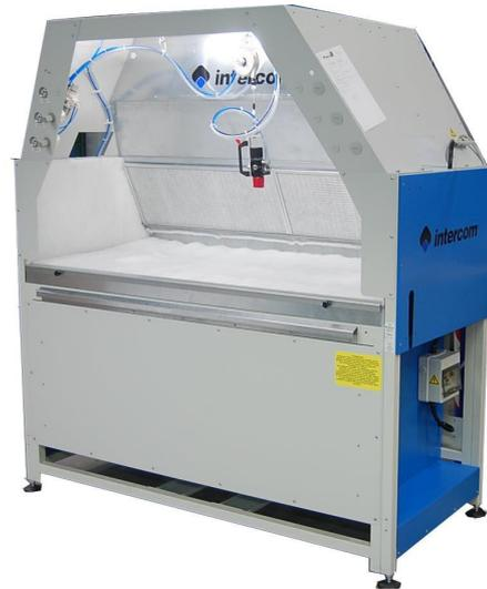
El banco es equipado con un plafon con neon. La estructura es pensada para poder, mas tarde, meter el automatismo de movimiento y secado introducido con el Step. De esta manera, tambien una empresa pequena puede afrontar la optimizacion de las fases de encolado sin perder nada de la inversion anterior. La pistola, sustentada por un enroyador que permite manejarla facilmente, puede ser accionada a mano o por medio de un pedal para dejar libres las manos del operador.
